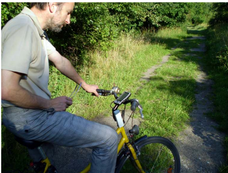
Abbildung 1 Der PDA ( personal digital assistant ) und das Akku-Pack lassen sich leicht am Fahrrad montieren.
