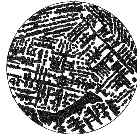
Abb. 1. Mikroskopzeichnung des Dünnschliffs der Schlacke von Hollingstedt. Weißer Untergrund: Olivinkristalle. Schwarz: Magnetit.
